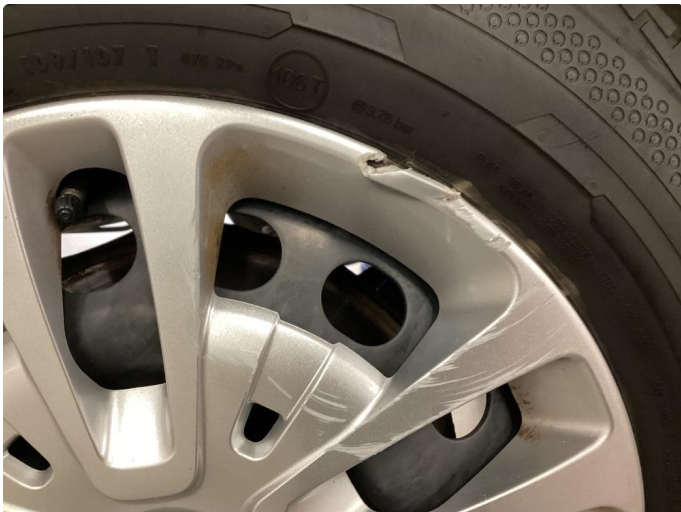
1.2 Hjul kapsel skadet
