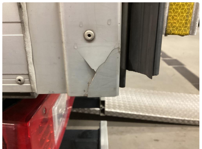
1.3 Sprukket plast nedre hjørner på skap
