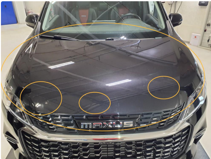
1.1 Steinsprut er penslet
