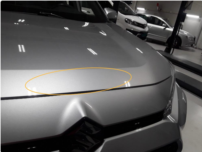
1.1 Steinsprut, er penslett med lakkstift
