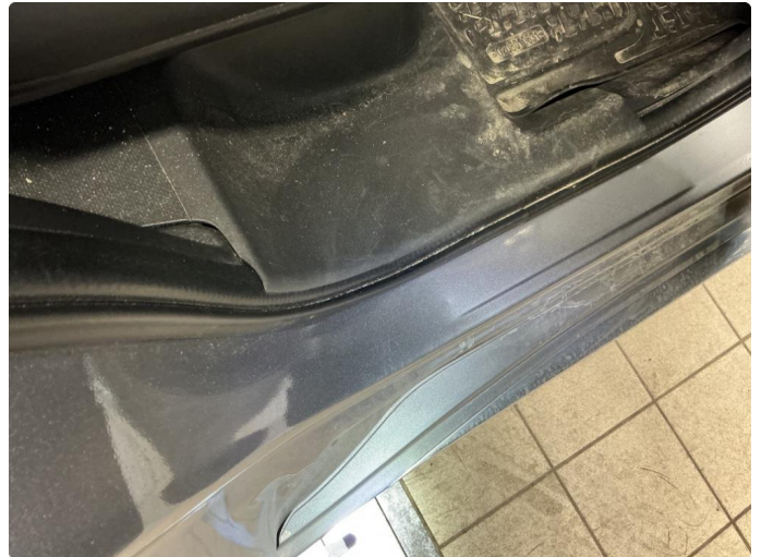
1.1 Noen riper og småbulker
