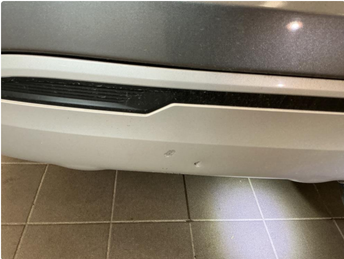
1.1 Noen riper og småbulker
