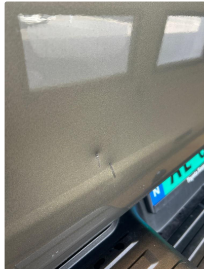
1.2 Ripe(r) ned til grunning
