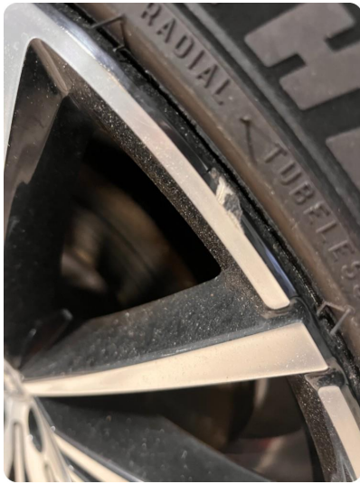
1.1 Kantkjørt felg Diamond Cut Skade på venstre fram felg.
