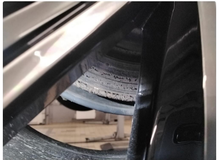
2.1 Mer enn 25% rust.
