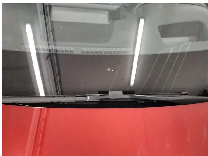
1.2 Steinsprut på frontruten. Nedre midten.
