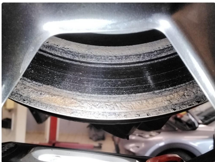
3.1 Ca 25% rust på utsiden av skivene bak. Delvis gravrust.
