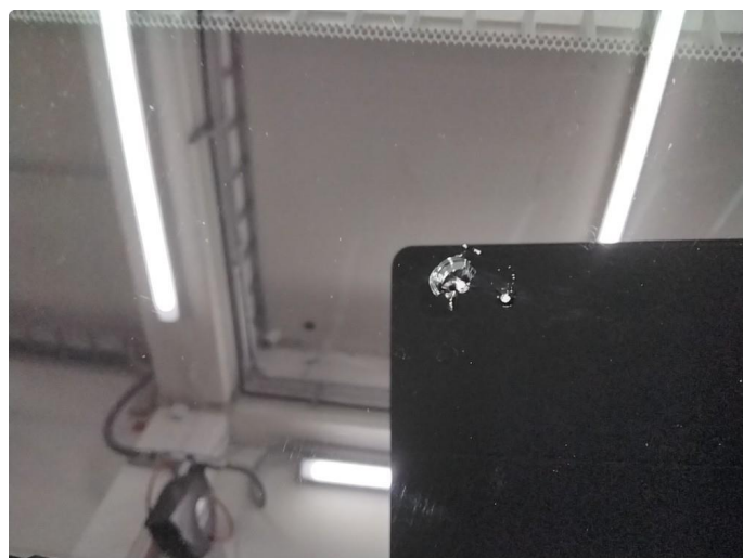
1.2 Steinsprut på frontruten. Nedre midten.
