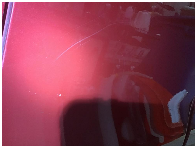
1.1 Noen små hakk i lakken på dør venstre side.
