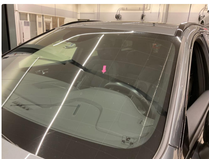
1.2 Liten steinsprut i synsfelt som er limt
