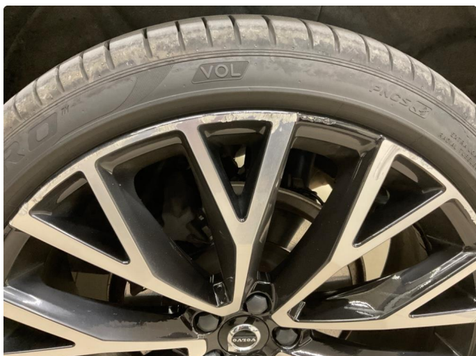
1.1 Kantkjørt felg Diamond Cut
