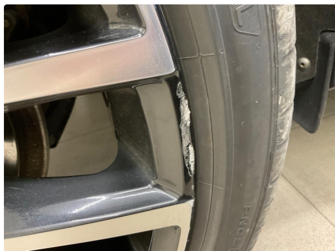
1.1 Kantkjørt felg Diamond Cut
