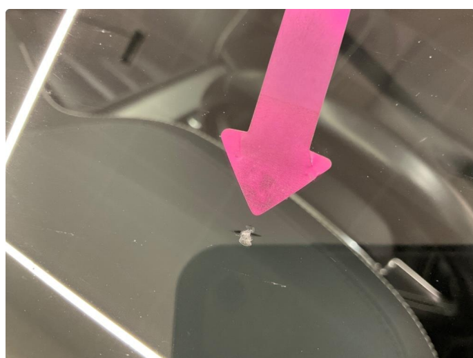
1.2 Liten steinsprut i synsfelt som er limt
