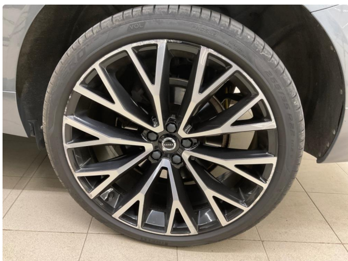
1.1 Kantkjørt felg Diamond Cut
