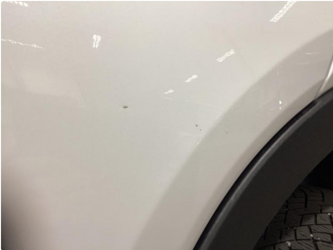
1.1 Steinsprut / Normal brukslitasje
