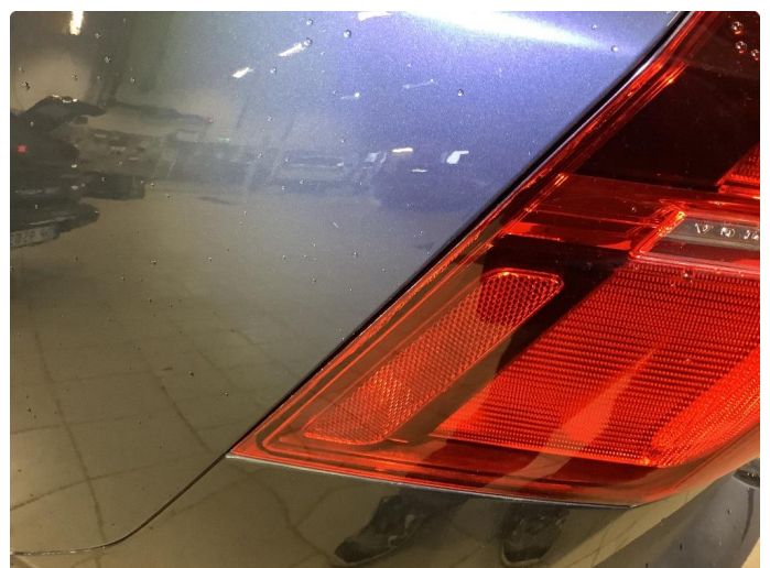
2.1 Krakelering i plast, skiftes på garanti
