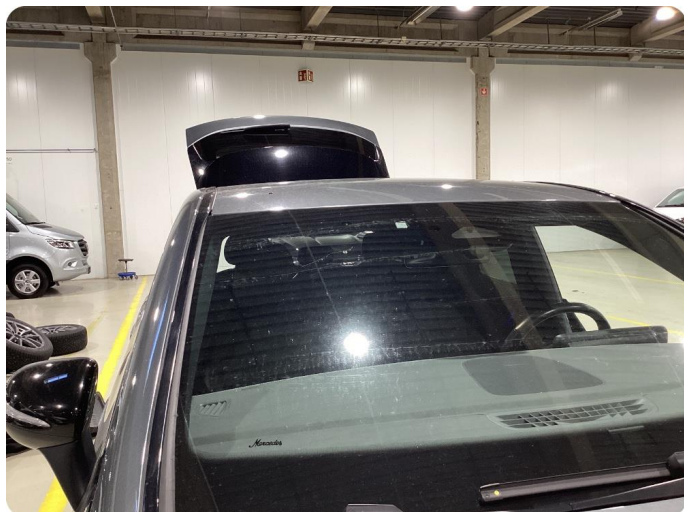
1.2 Steinsprut med sprekk
