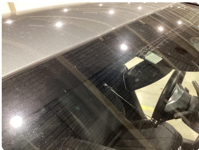
1.2 Steinsprut med sprekk
