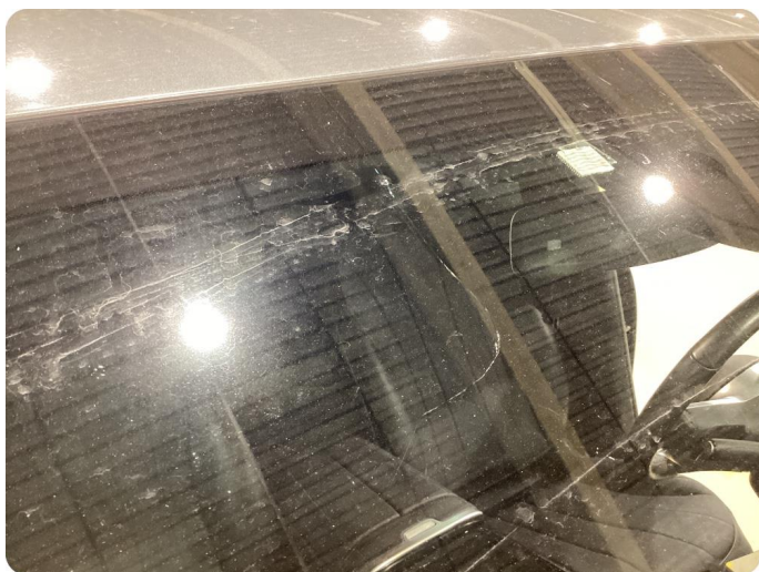
1.2 Steinsprut med sprekk
