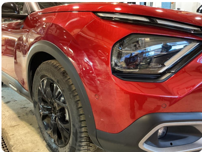
1.2 Generelt mye bruksslitasje Riper h.f på framganger. Jon Martin kan få det bedre, men må kanskje lakkeres
