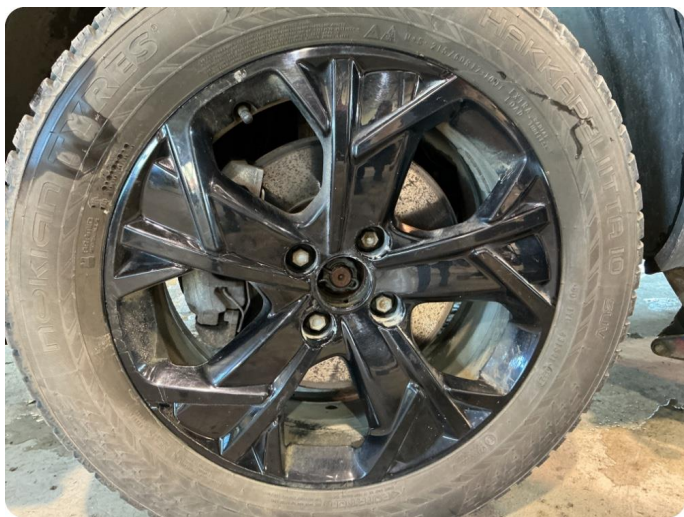
1.4 Øvrige feil Små skader på alle felger. Alle felger mangler senserkopp
