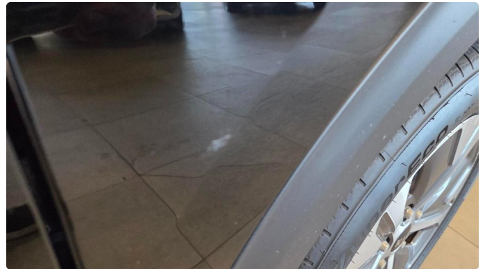
1.2 Bruksslitasje - Diverse steinsprut og riper rundt om.
