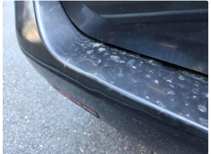
1.1 Bruksslitasje - Riper og merker bakfanger.
