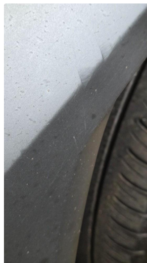
1.2 Skjermbue høyre foran - Hakk/sår i plast
