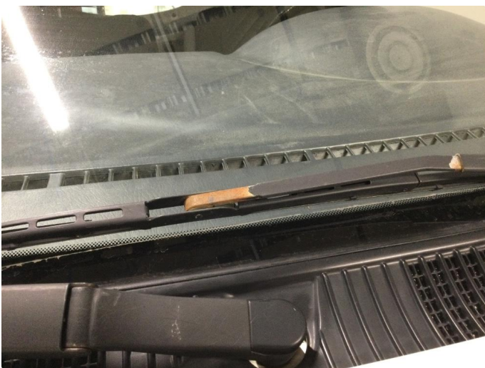
1.1 Flekkvis noe korrosjon/rust
