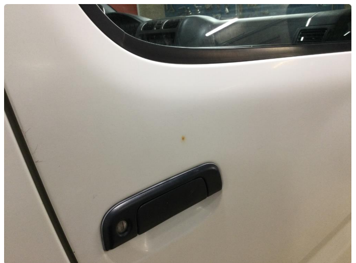
1.1 Flekkvis noe korrosjon/rust
