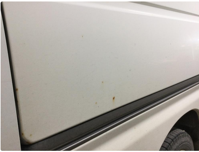
1.1 Flekkvis noe korrosjon/rust
