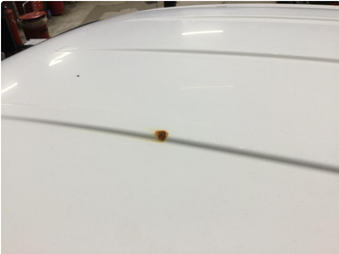
1.1 Flekkvis noe korrosjon/rust
