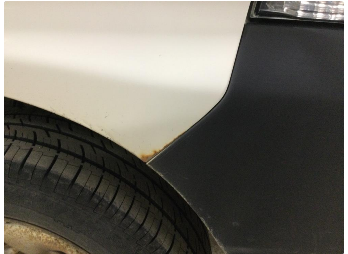
1.1 Flekkvis noe korrosjon/rust
