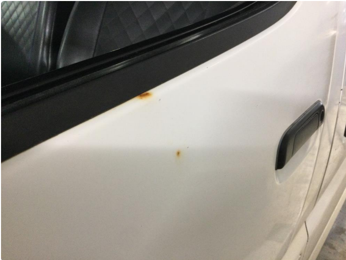
1.1 Flekkvis noe korrosjon/rust
