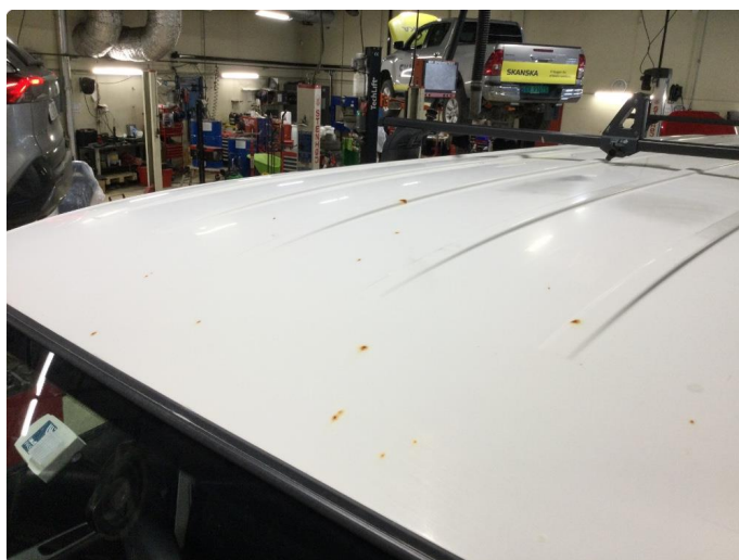
1.1 Flekkvis noe korrosjon/rust
