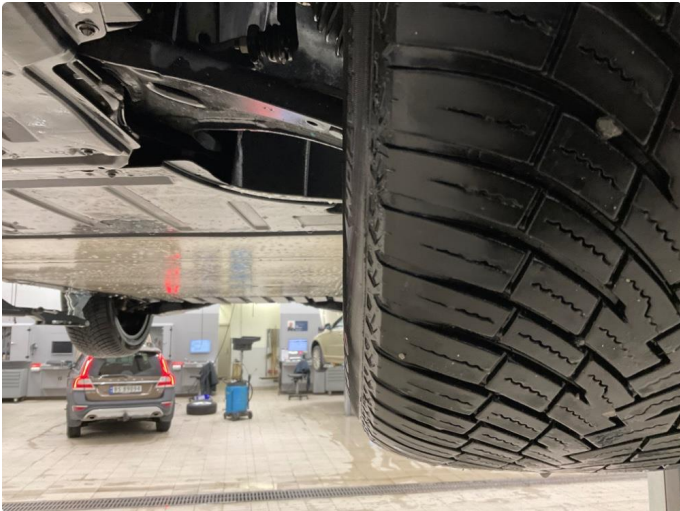
1.1 Skjev slitasje på sommerdekk
