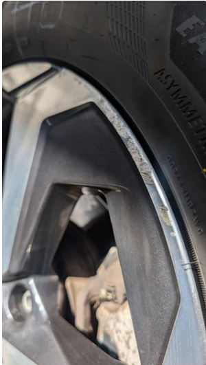
1.1 Liten skramme på v.bak felg - normal slitasje iht alder & km
