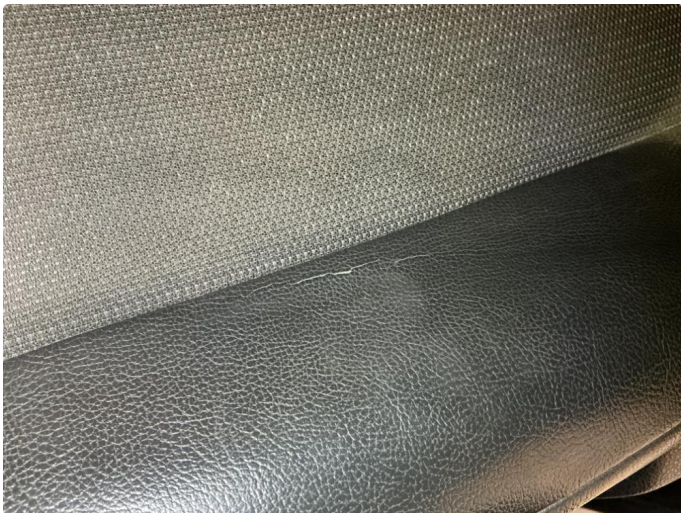
1.1 Lita sprekk i setetrekk venstre sittepute fram
