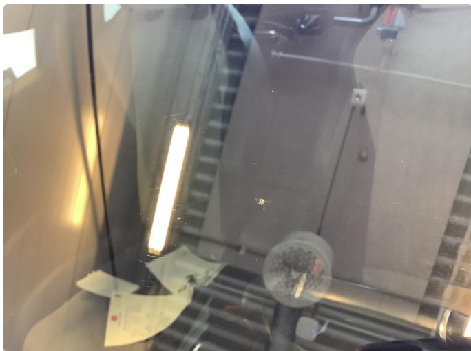
1.1 Lite steinsprang frontrute, reparert
