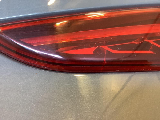
1.1 Liten kosmetisk sprekk i indre baklykt høyre side
