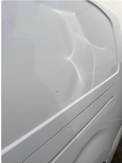
1.1 Steinsprut - begynt å ruste
