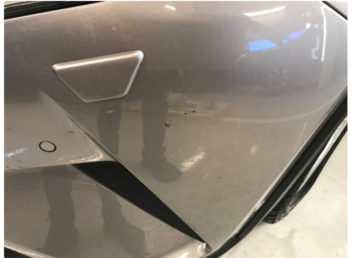
1.1 Steinsprutskade, kan pensles. Ingen rust.
