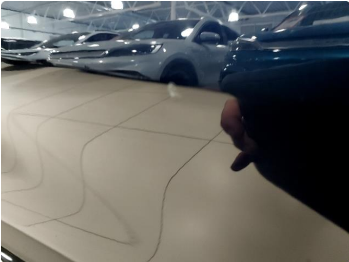
1.1 Lite hakk i h.dør foran - ikke igjennom grunning
