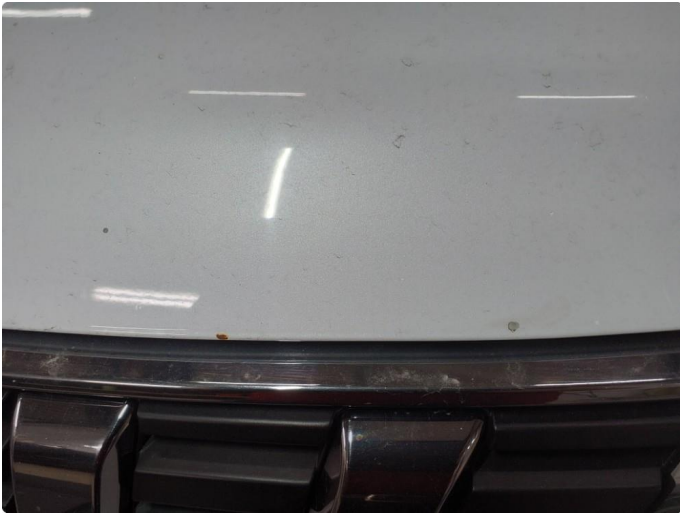
1.1 Noe steinsprut med rust
