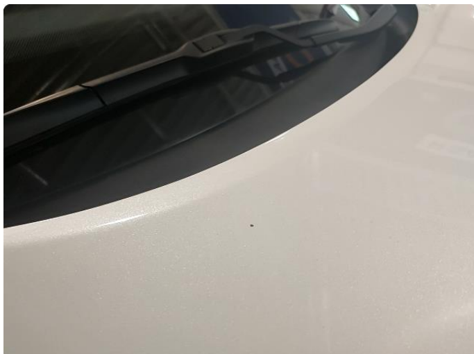
1.1 Steinsprut, ikke rust
