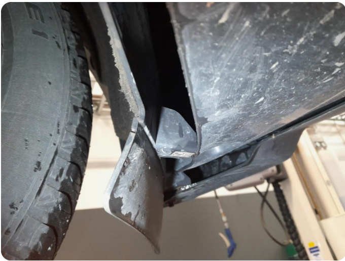
1.1 Beskyttelsesplate skadet/mangler Løse innerskjermer begge sider foran. Mangler skruer.
