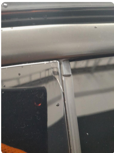
1.4 Øvrige feil Krakkelering på pyntedeksel på begge bakkdører. Garanti
