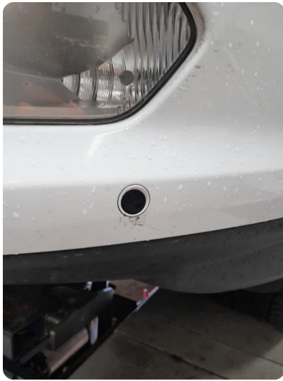
1.1 Øvrige feil En parkeringsensor foran som ikke er lakkert
