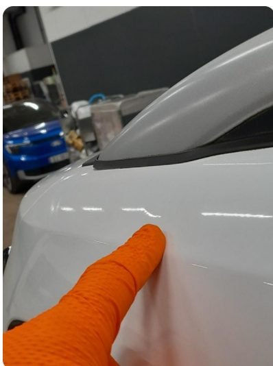
2.5 Bulk To småbulker på tak h side.
