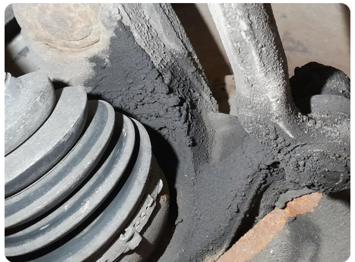
6.1 Øvrige feil Ser spor av fett ved hjulnav v side foran. Kan ikke finne noe søl eller skade på drivakselmansjett. Mulig dette er gammelt og at feilen har blitt utbedret. P.s Ny nedre bærekule på samme side.
