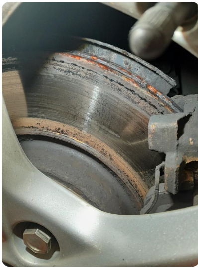
5.1 Rust Noe slitekant + rust på bremsler. Er innenfor.
