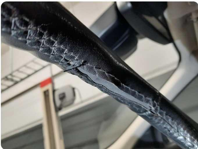
7.2 Slitt Søm på ratt har gått opp. Mulig dette kan sys. Blir dyrere hvis rattet må skiftes!
