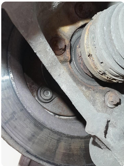
5.2 Mangler Mangler bremseskjold h side bak + rustet hull v side bak
