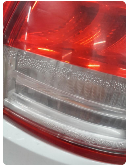
3.1 Dugg/fukt Dugg i baklamper, ytre h side og indre v side
