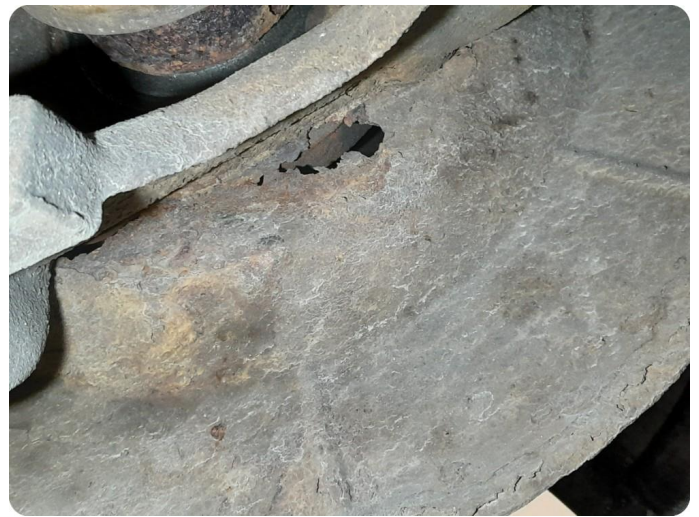
5.2 Mangler Mangler bremseskjold h side bak + rustet hull v side bak
