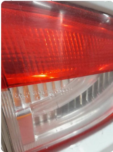
3.1 Dugg/fukt Dugg i baklamper, ytre h side og indre v side
