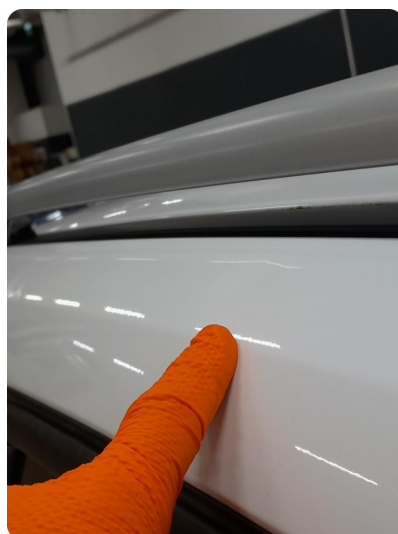
2.5 Bulk To småbulker på tak h side.
