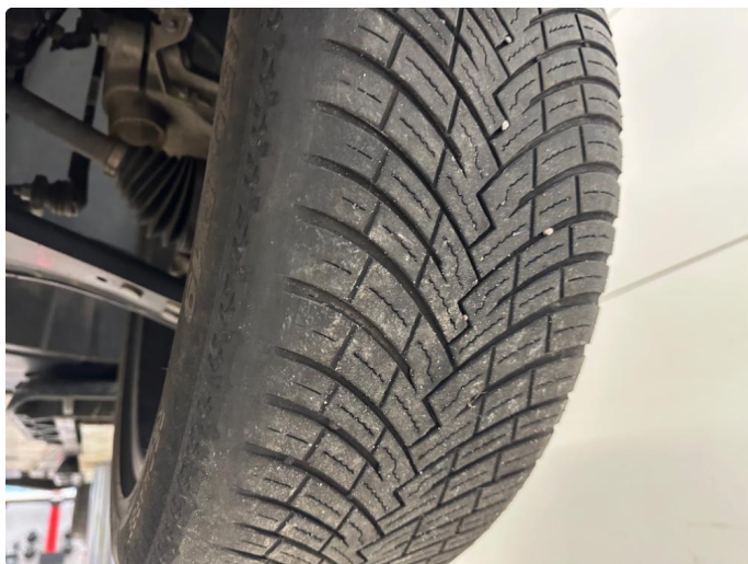
1.3 Skjev slitasje på sommerdekk
