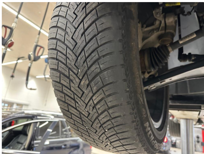
1.3 Skjev slitasje på sommerdekk
