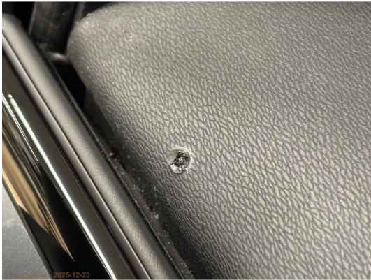
1.1 Liten skade på dørtrekk VF
