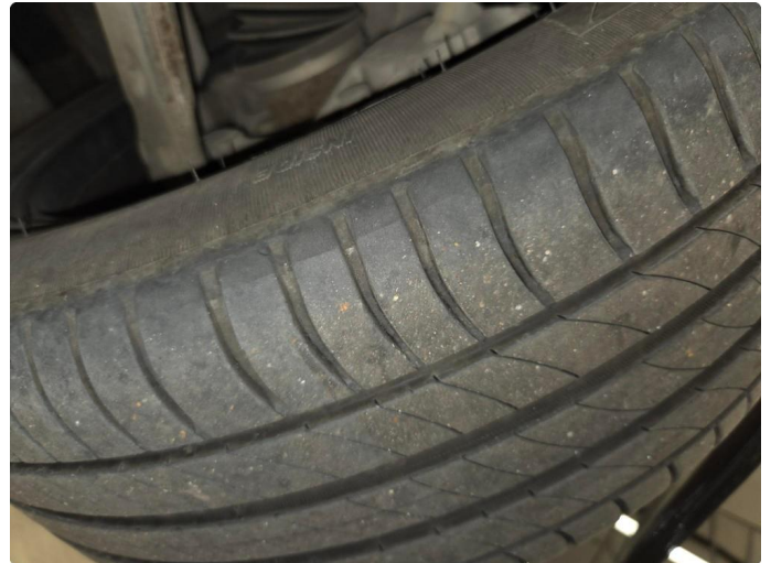
1.1 Skjev slitasje på sommerdekk. Har justert hjulvinkler
