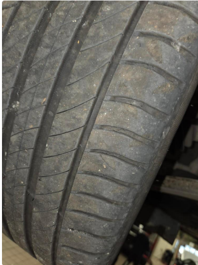
1.1 Skjev slitasje på sommerdekk. Har justert hjulvinkler
