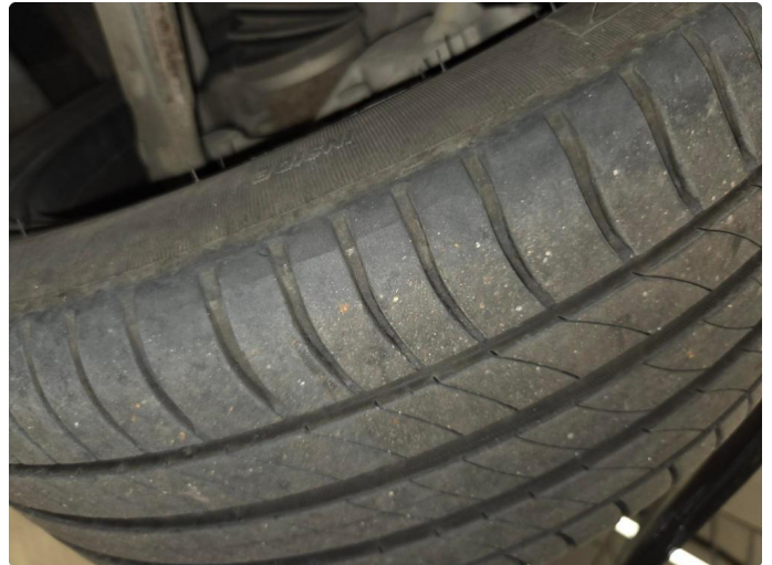
1.1 Skjev slitasje på sommerdekk. Har justert hjulvinkler
