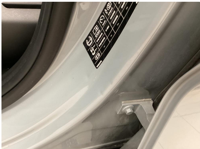
1.1 Lite hakk i døråpning førerdør.
