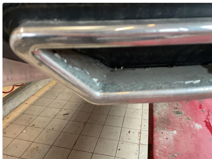
1.4 Krakelering på lister bak fanger
