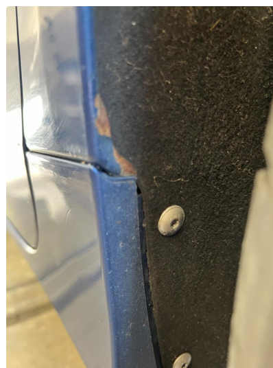
1.2 Korrodert steinsprut hjulbuer foran.
