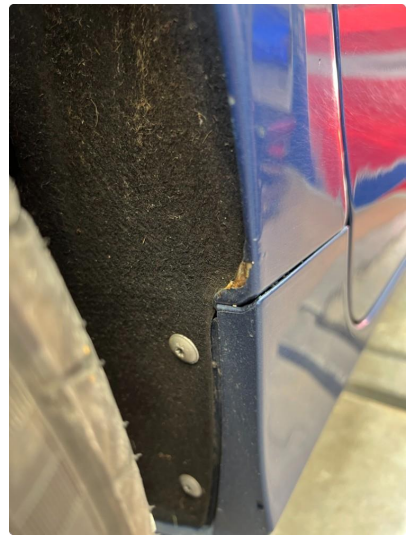
1.2 Korrodert steinsprut hjulbuer foran.
