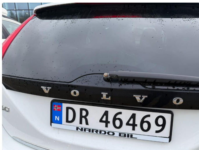
1.3 Mangler deksel pusserarm bak.
