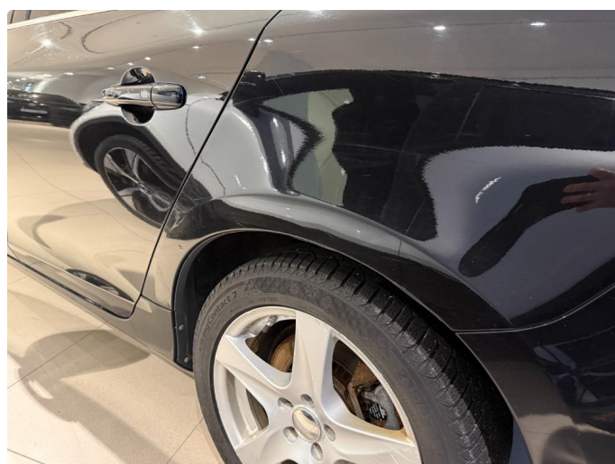
1.3 Korrosjon hjulbue venstre bak.
