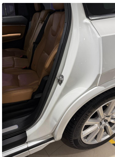
1.3 Bruksslitasje døråpninger bak.
