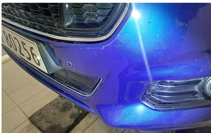
1.4 Støtfangr foran. Riper og steinsprut.
