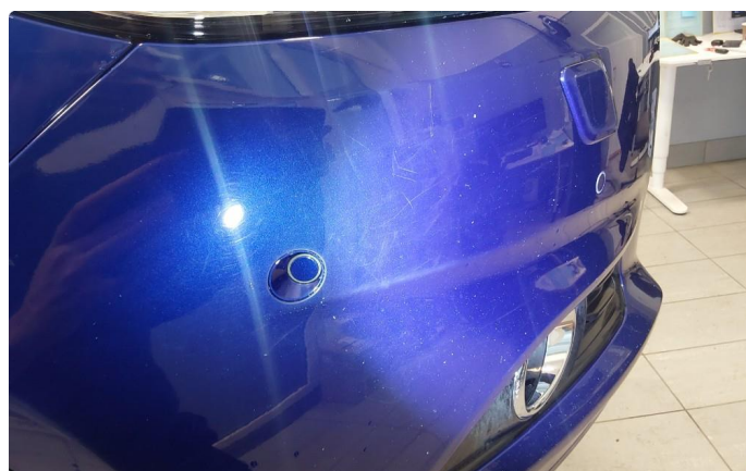
1.4 Støtfangr foran. Riper og steinsprut.
