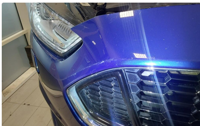
1.4 Støtfangr foran. Riper og steinsprut.
