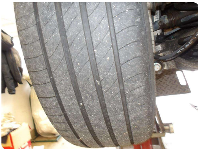
1.4 For liten mønsterdybde sommerdekk Gjelder begge bakdekk sommer. Godkjent pr.nå ( er ca 2mm mønster ) Nærmer seg minimum for skifte. Bør skifte før salg til ny kunde
