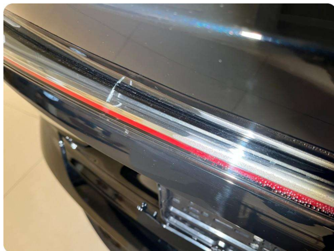
2.1 Defekt / sprukket glass Midtre baklykt i bakluke har sprikker + dugg ( garanti )
