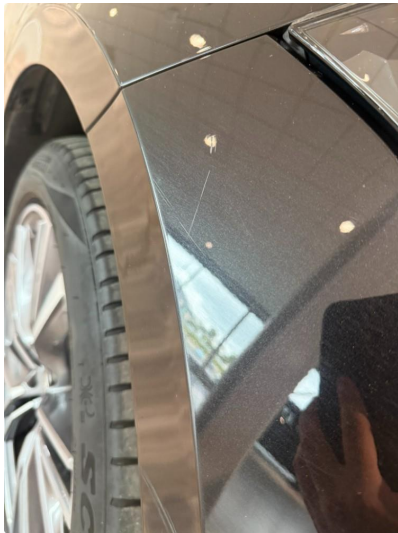
1.3 Liten skrape/steinsprang på skjerm høyre foran
