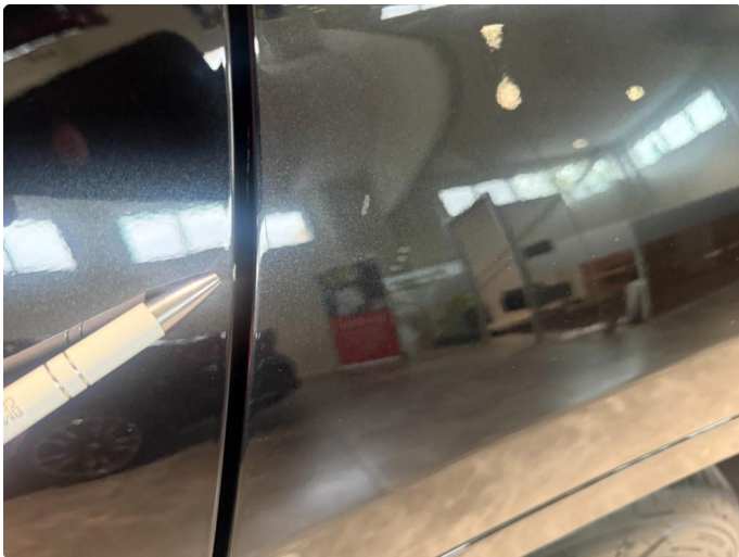
1.1 Lite hakk i døråpning.
