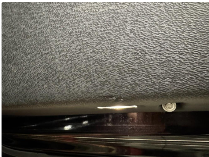
3.1 Skadet/merker etter utstyr
