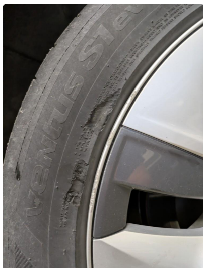
1.2 Dekkskade sommerhjul, blir fikset.
