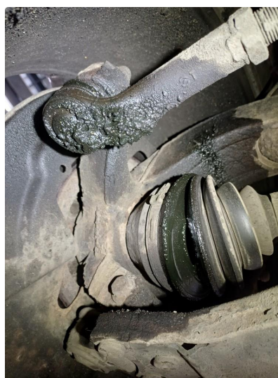
4.1 Drivaxelmansjett defekt, blir byttet.
