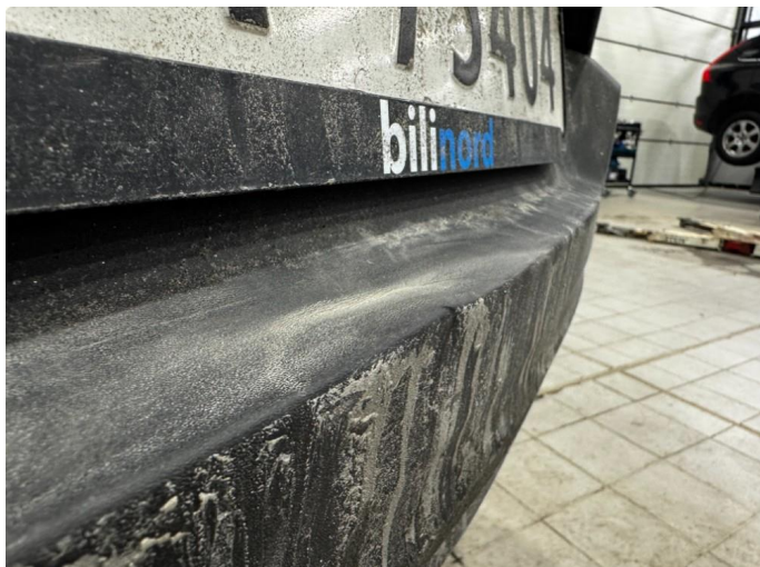
1.2 Liten skade på bakfanger
